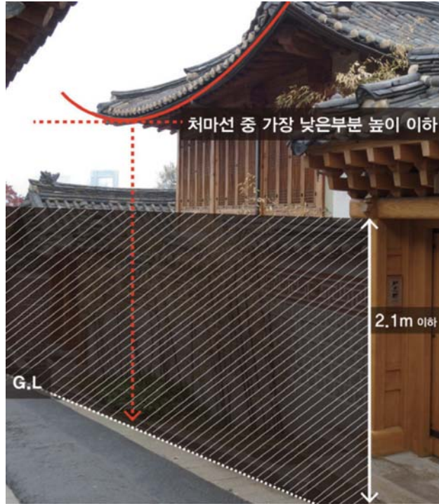
[예시] 복촌 한옥마을 담장의 높이기준 출처: 이강만이세진(2015), “한옥정책 브리프 40호, 한옥건축기준의 제정목적 및 주요내용”, 건축도시공간연구소 국가한옥센터, p.11
